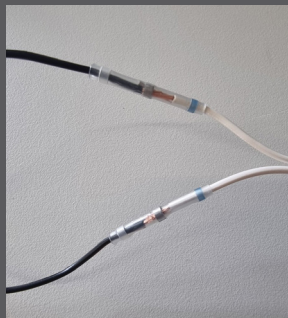
Montage mit Lötschrumpf-Verbinder (wenn wenig Platz vorhanden)
